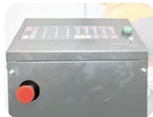
Кнопка аварийного останова
